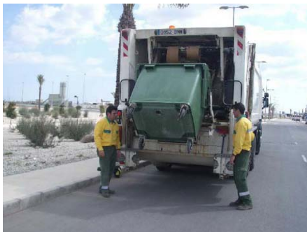
Recogida de R.S.U. mediante carga trasera
